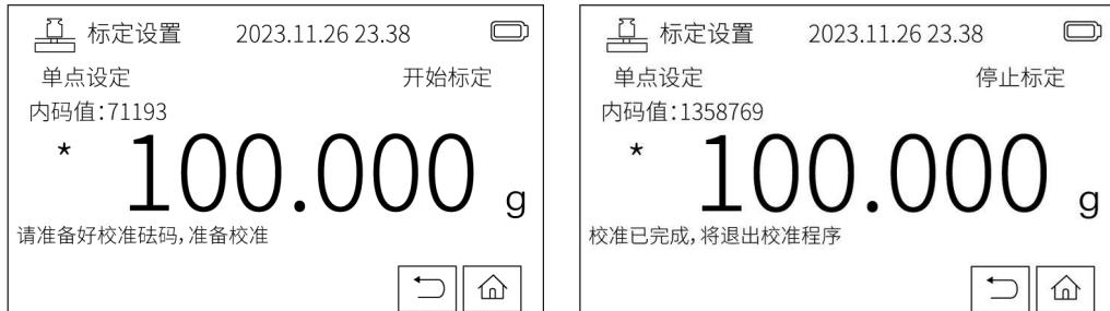
注：高精度的密度计测量样品密度时，测量结果的准确度依靠对样品重量的准确测量，为获得准确的测量结果，密度计在以下使用场景下，必须经过校准方可使用：当密度计首次使用时；当密度计被移动至别处；当使用环境条件改变时；使用时定期的调整。
