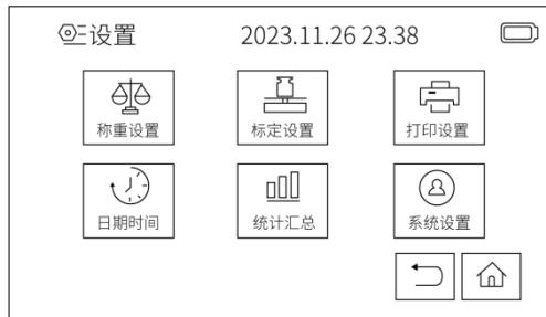
②此时进入标定界面，点击“开始标定”字样，屏幕上砝码数值将闪烁不断，此时放置相对应的标配砝码于测量台上，等待校准。
