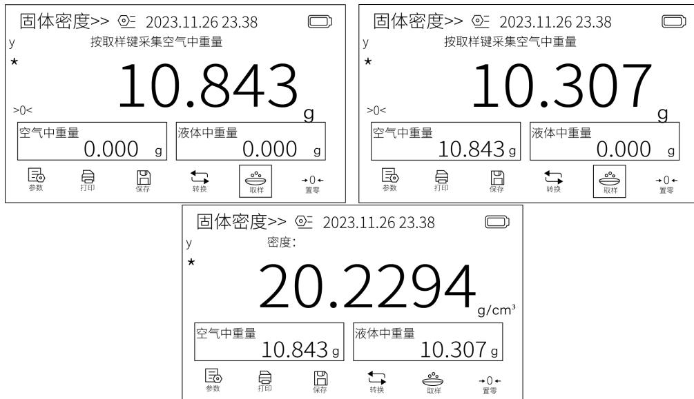
③随即显示屏直接显示出密度值，点击“转换”可切换样品的体积、纯度值，点击“储存”可保存测量数值，点击“打印”可通过连接打印机输出测量数据。
