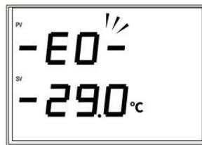
! 温度传感器故障或超出量程范围蜂鸣器鸣叫，PV窗口闪烁显示“-E0-”。
