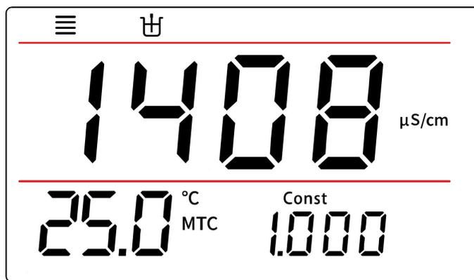
图 11 4 寸平衡测量数据稳定界面示意图
