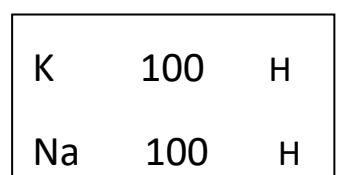
K 的“开关”键和 Na 的“开关”键，可以打开或者关闭 K 元素和 Na 元素的显示值。通过按面贴上面的“打印”键可以直接打印出当前的测试数值。
