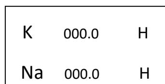
通过按 K, Na 的调整键“▲”“▼”，进行数值调节，调节到低标 0 数值，再次按 K 的“低标”键和 Na 的“低标”键进行数据校正，之后自动进入测试界面。
