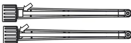
(3) 将排液管末端插入出液阀，并锁紧排液管；
